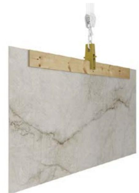
Anstelle einer **Doppelklemme** ist auch eine **Einzelklemme** verwendbar. Ihr Greifbereich ist mit einem Holzbalken 300x20x2 cm zu erweitern. Damit werden Dreh- und Verdrehbewegungen unterbunden, die zum Bruch der Platten führen könnten.
